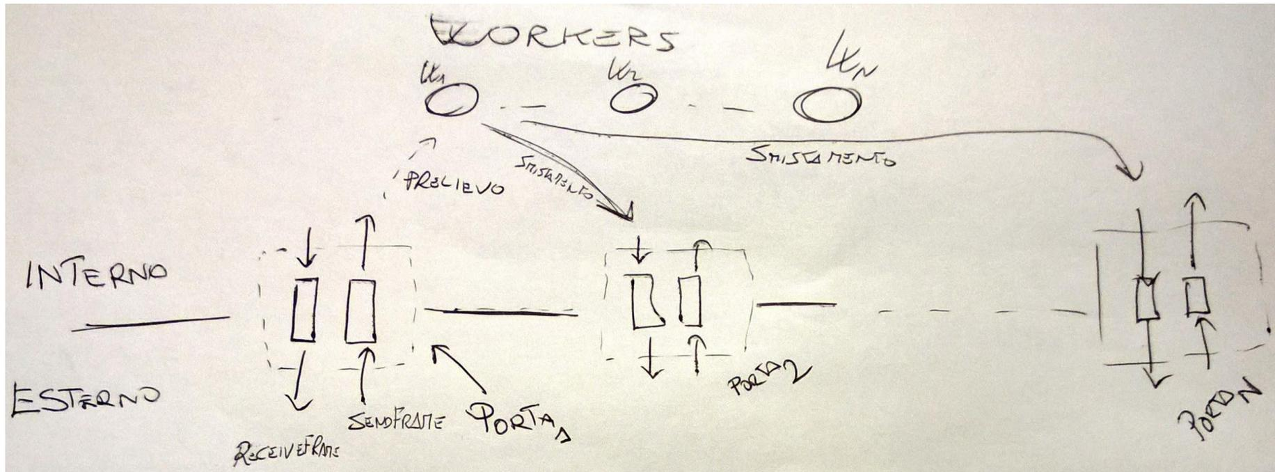
Si noti che i Worker ESTRAGGONO dai buffer di INGRESSO delle porte, e INSERISCONO nei buffer di USCITA delle porte. Pertanto un Worker non usa `sendFrame` e `receiveFrame`, poichè questi metodi, rispettivamente INSERISCONO nei buffer di INGRESSO delle porte ed estraggono dai buffer di USCITA (l'esatto opposto del lavoro di elaborazione di un Worker che lavora internamente a uno switch).
