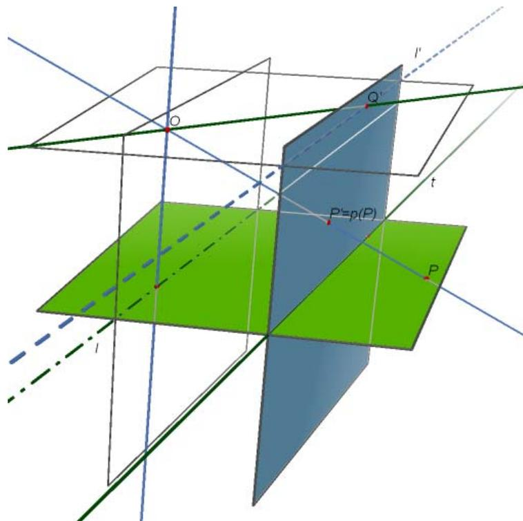
5. Nello spazio ampliato con gli elementi impropri, sono dati due piani  $\alpha$  e  $\alpha'$ , che si incontrano in una retta  $t$ , ed un punto  $O$  fuori da  $\alpha$  e  $\alpha'$ . Sia  $p: \alpha \rightarrow \alpha'$  la proiezione da  $O$  di  $\alpha$  su  $\alpha'$ . Si chiama *retta limite di  $\alpha$*  la retta  $l$  la cui proiezione è la retta impropria  $r'_\infty$  di  $\alpha'$ .
