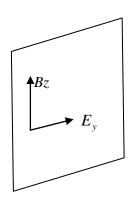
La variazione temporale della componente y del campo elettrico è accoppiata alla variazione della componente z del campo magnetico rispetto ad  $\mathbf{x}$  .
